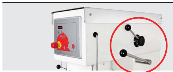
VL-1 Manuell hastighetsreglering och kittelnedsänkning
